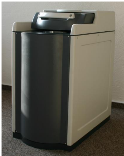
放射性物質測定器 (ガンマー線スペクトロメーター) チェコ GEORADIS社製 RT-50
