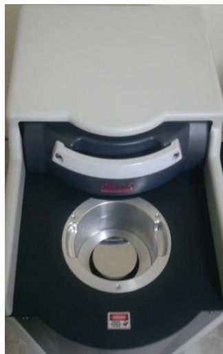
放射性物質測定器 (ガンマー線スペクトロメーター) チェコ GEORADIS社製 RT-50
