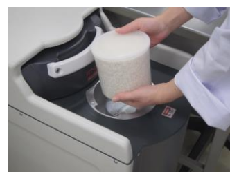
放射性物質測定器 (ガンマー線スペクトロメーター) チェコ GEORADIS社製 RT-50
